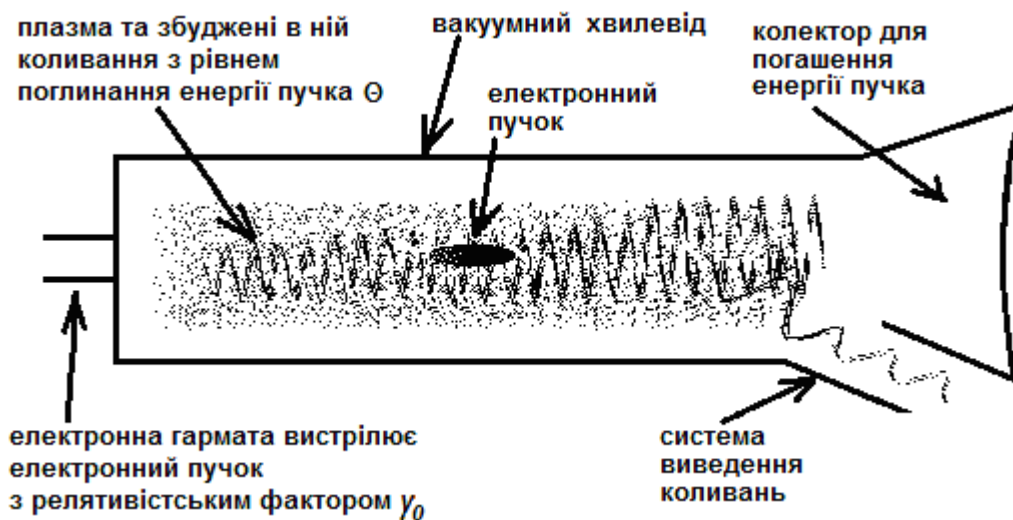
Рисунок 1.1 – Основні елементи конструкції пучково-плазмового НВЧ генератора
